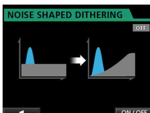
2. Pulse el botón **F4 (ON/OFF)** para activar la función de modulador de ruido (ON).
